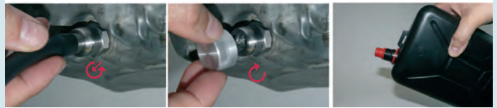
Schlauchanschluss mit halber Umdrehung entriegeln und abziehen.
