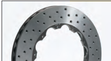
D95 Gelochte Bremsscheibe mit versenkten Bohrungen. Für den Einsatz im Motorsport empfehlen wir die genuteten Ausführungen. Gelochte Scheiben sind anfälliger für Rissbildung, allerdings sind in manchen (vor allem älteren) Fahrzeughomologationen gelochte Scheiben vorgeschrieben.
